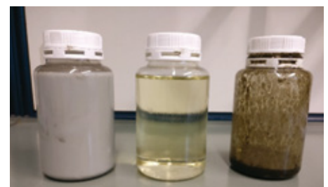
Verbrauchte Kühlschmierstoffe (Automotive) (vlnr Zulauf, Ablauf, Konzentrat)
